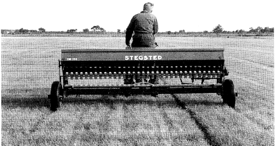
Deze kunstmeststrooier is speciaal vervaardigd voor proefvelden.
