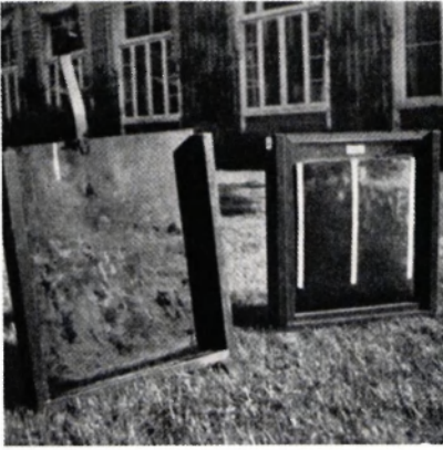
Proefbakken. Bij de linkerbak is de ijzeren plaat zichtbaar, waarmede de grondkolom is doorgesneden.
