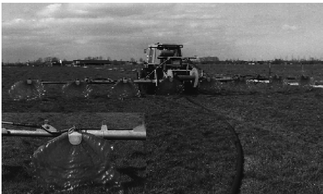
Door verdunde mest met een slang aan te voeren kan schade door berijding voorkomen worden. De sproeiboom zorgt voor een goede verdeling van de mest.
