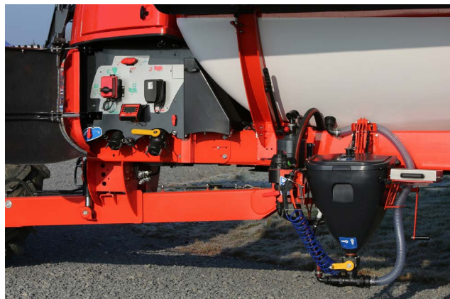
Om emissies te voorkomen, loopt de vulleiding onder de fustreiniger door. Dankzij de venturiwerking ontstaat onderdruk en is de kans op verwaaien van druppels nihil.
