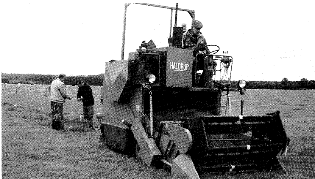
De speciale proefveldmaaimachine kan in één werkgang maaien én wegen.
