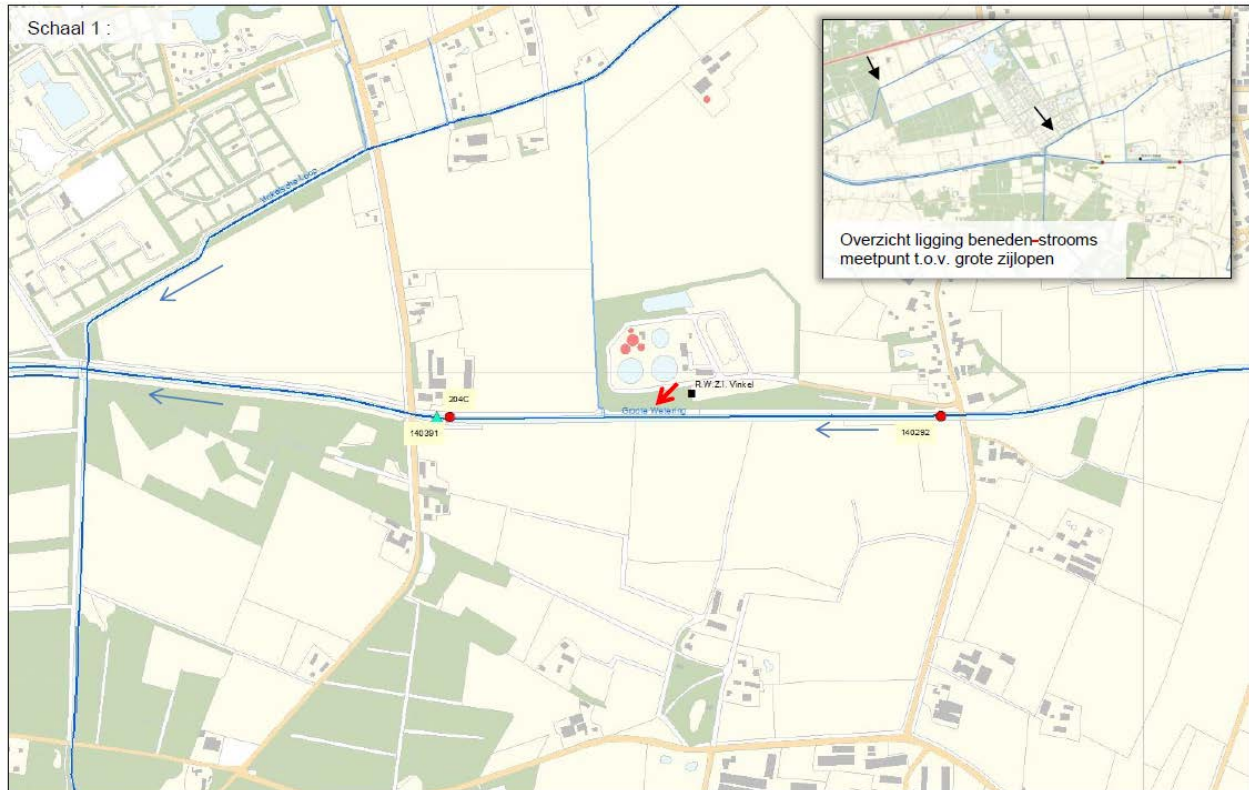
Figuur 7A: Ligging meetpunten waterkwaliteit (rode stip) en waterkwantiteit (blauwe driehoek) ten opzichte van rwzi Vinkel in de Groote Wetering. Rode pijl geeft lozingspunt van het effluent weer (van Zuilichem and Verberkt 2018).
