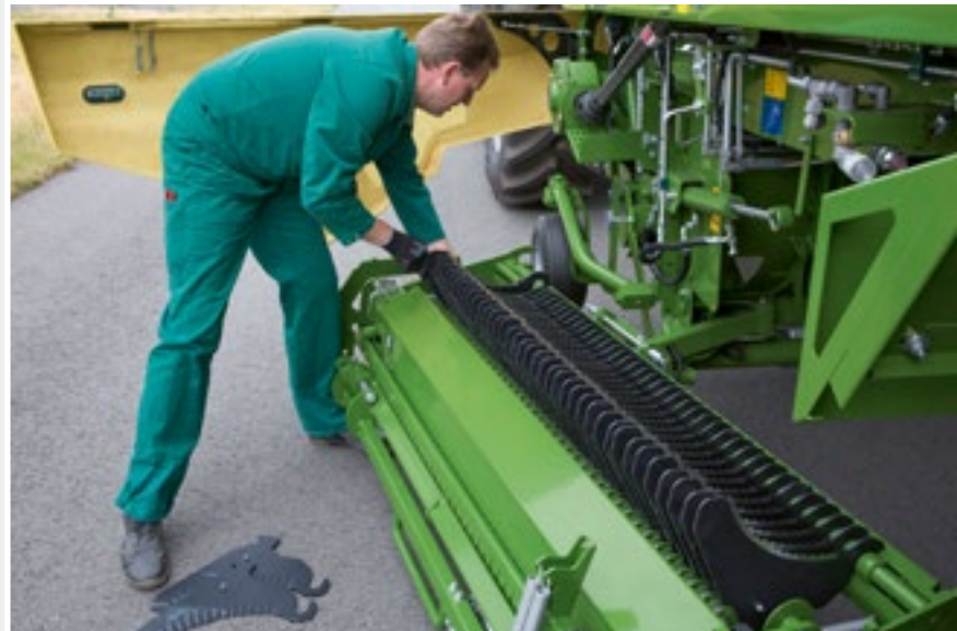
Een uitklapbare messenbalk maakt van messen wisselen een koud kunstje. Krone en Pöttinger leveren het standaard, bij Fendt is het meestal een optie.
