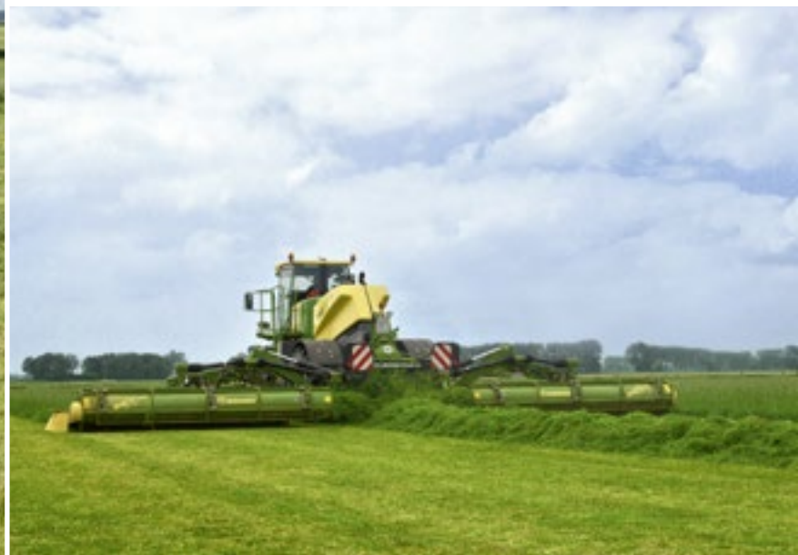
De Krone Big-M-maaiers werken het gras naar het midden met behulp van een vijzel en niet met dwarsbandjes die je vaak bij triple-maaiers ziet.
