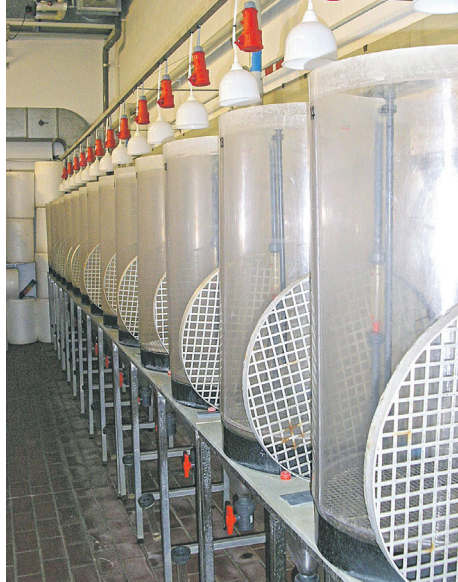
Figuur 3. Een opstelling van metabole tanks. De witte roosters worden tijdens het experiment in de tanks geplaatst (zie Figuur 2).
