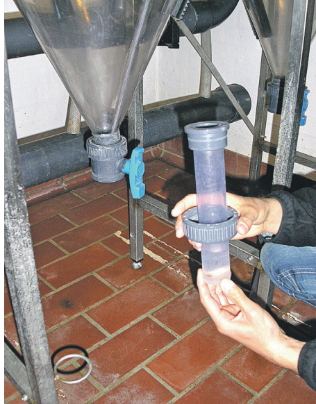
Figuur 4. Detail het conisch gedeelte onderaan de tank en de kraan en de (afgeschroefde) buis voor het opvangen van de feces. De kraan dient voor het afsluiten van de tank zodat de buis kan worden afgeschroefd om de feces te verwijderen.
