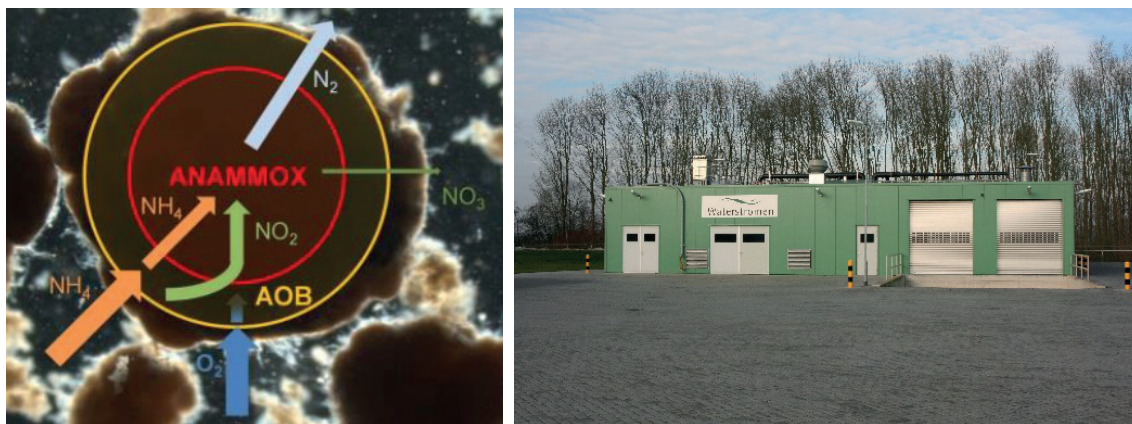
FIGUUR 7 SCHEMATISCHE WEERGAVE VAN PROCESSEN IN DE ANAMMOX KORREL (BRON H2O-ONLINE / 15 SEPTEMBER 2016); RECHTS DE ANAMMOX INSTALLATIE BIJ WATERSTROMEN
