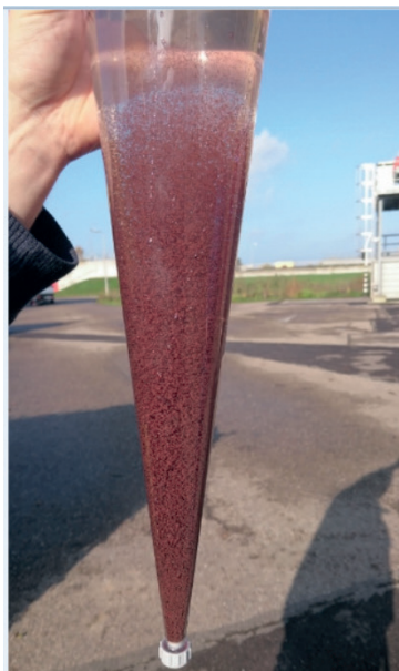
FIGUUR 6 ANAMMOX UIT EEN DEMON REACTOR, RWZI LAND VAN CUIJK
