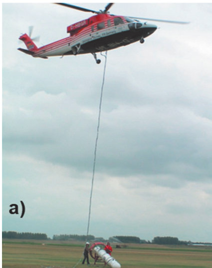
Afbeelding 6: (a) Het Helicopter ElectroMagnetic (HEM)-systeem van BGR (Bundesanstalt für Geowissenschaften und Rohstoffe), gebruikt voor de kartering van de zoetzoutverdeling in de ondergrond van Zeeland; (b) vergelijking van vier zoutprofielen gemeten door elektrische sonderingen (ECPT) met die gemeten door HEM, tijdens een pilot op Schouwen-Duiveland (De Louw e.a., 2011b).
