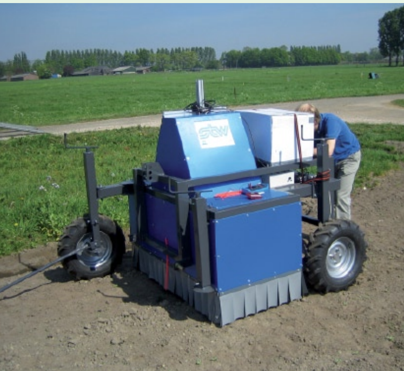
Meetopstelling voor gewas en onkruid opnamen die is gebruikt in het veld.
