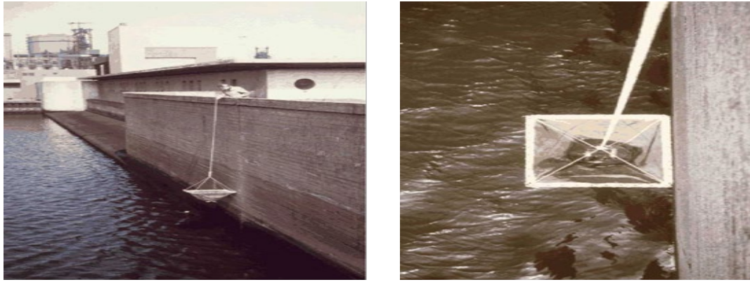
Figuur 6.1 Zijaanzicht (L) en bovenaanzicht van de glasaalbemonstering in IJmuiden. NB. Foto's zijn bij daglicht genomen ter illustratie, de bemonstering vindt echter altijd in het donker plaats. Foto's: W. Dekker.
