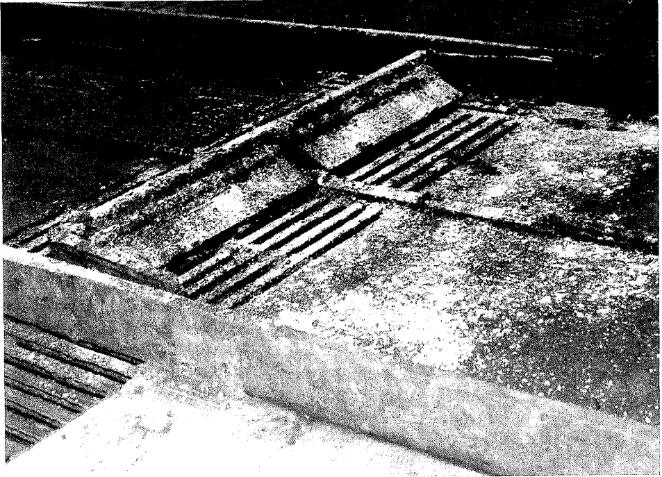
De combi-schuif boven de roosters waardoor de mest wordt afgestort. The combi scraper above the slats trough with the dung is tumbled down.
