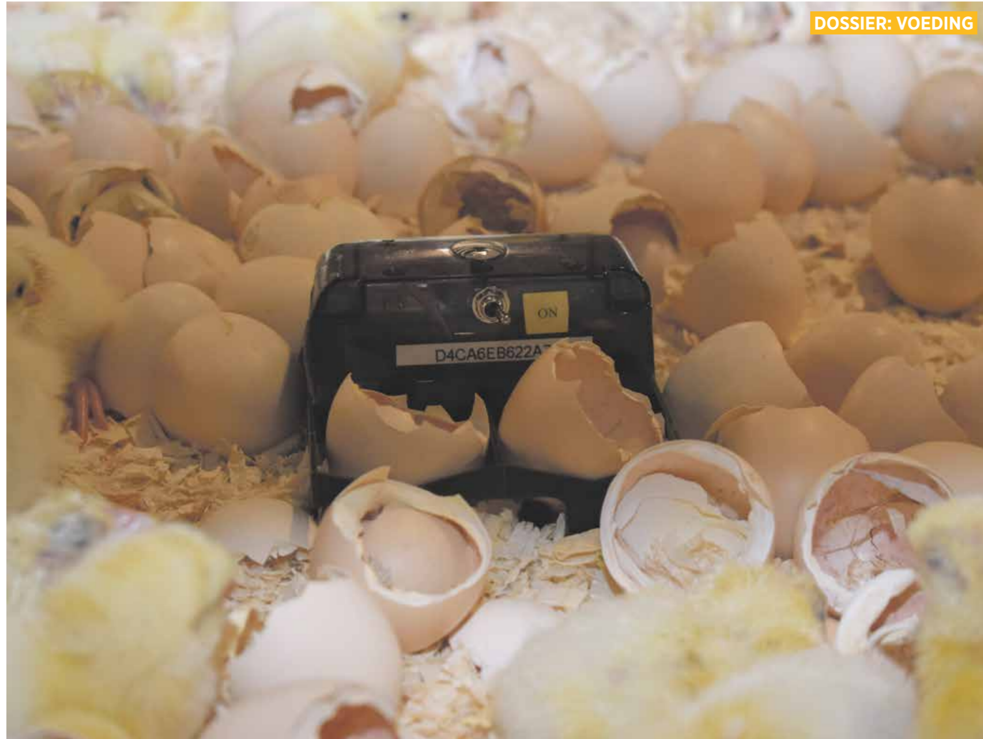
De loggers bestaan uit een set OVO-scans die tussen de eieren worden geplaatst en die continu de eischaltemperatuur en staltemperatuur meten. De pluimveehouder en broederij kunnen in realtime de situatie in de stal observeren via het platform www.mynestborn.eu . Bijsturen in overleg is dan snel mogelijk als dat nodig is.
