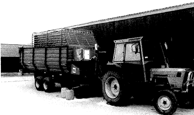
De opraapwagene met melassetoevoegapparatuur. The self-loading wagon with molasses dosing apparatus.
