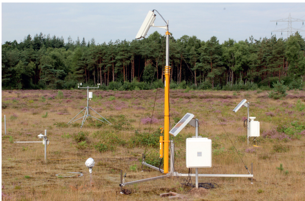
Afbeelding 2: Meetopstelling bij Soestduinen. Een thermische camera werd gebruikt om een meettechniek te toetsen gebaseerd op thermische beelden op verschillende lysimeters.
