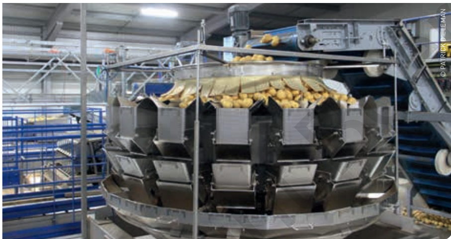
De machine stelt met 3 afgewogen delen een eindgewicht samen dat zo dicht mogelijk het opgegeven gewicht benadert.
