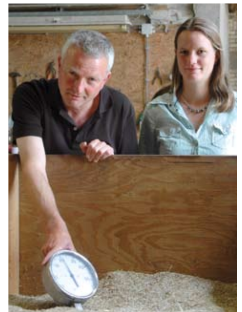
In de schuur van Sjaak staat een droogmachine: Een grote ventilator en een kachel, die de lucht door de achter elkaar geplaatste kisten graszaad blaast, voordat het de markt op gaat. De omgeving telt een beperkt aantal plekken met deze droogmachines, 'depots' geheten.
