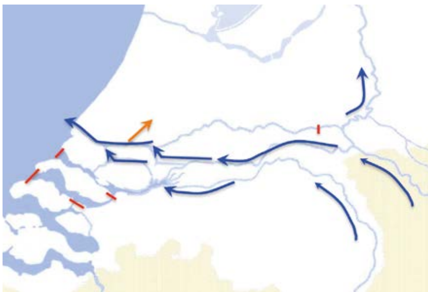
Schematisch overzicht van de huidige rivierdoorvoer in Nederland. Duidelijk is dat nagenoeg alle rivierafvoer over IJssel en Nieuwe Waterweg loopt. De Haringvlietsluizen fungeren daarbij als kraan, als die verder open gaat, gaat er minder water over de Nieuwe Waterweg en zal er meer zoutwater indringen richting Gouda (oranje pijl) (bron: WNF 2012).
