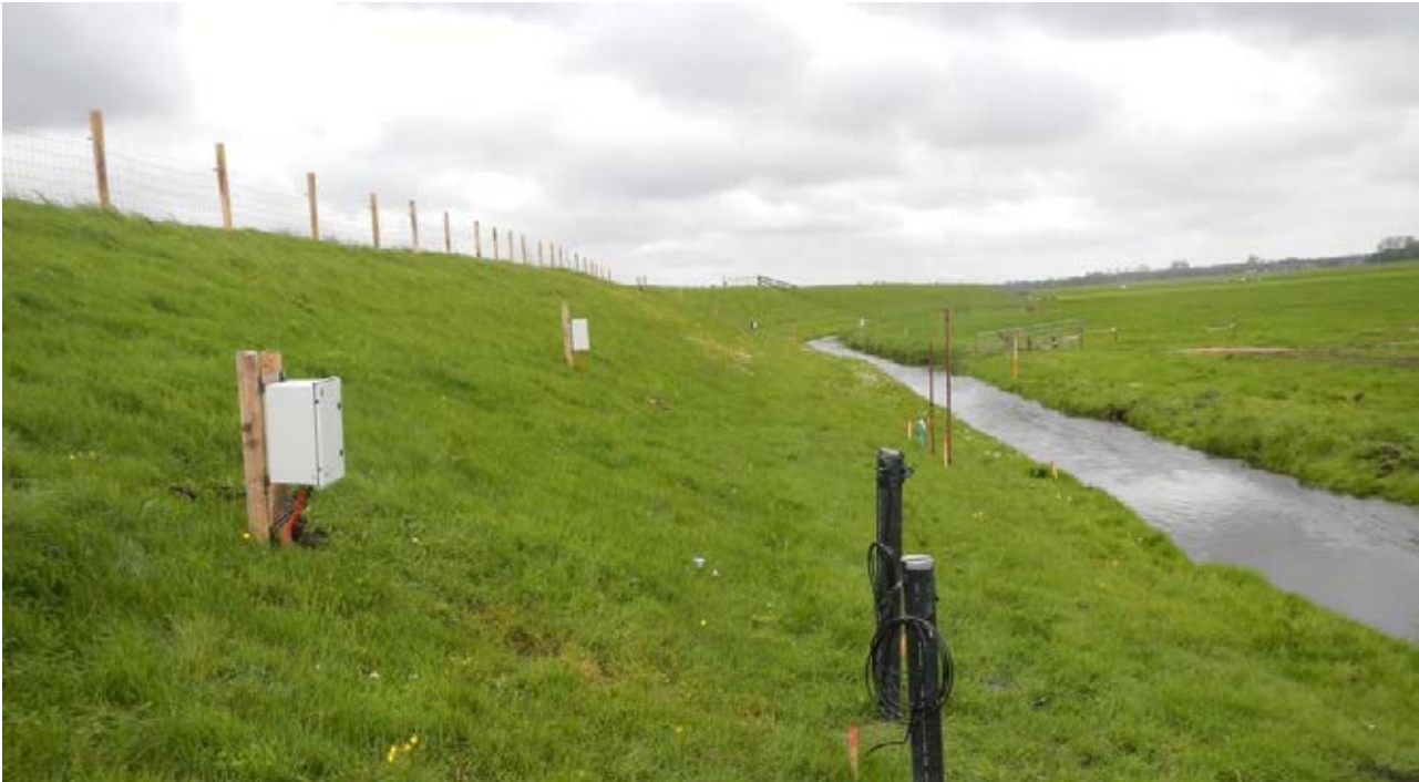
Figuur 8-20 Monitoringinstrumenten in dijklichaam (bron: Hoogheemraadschap Hollands Noorderkwartier).
