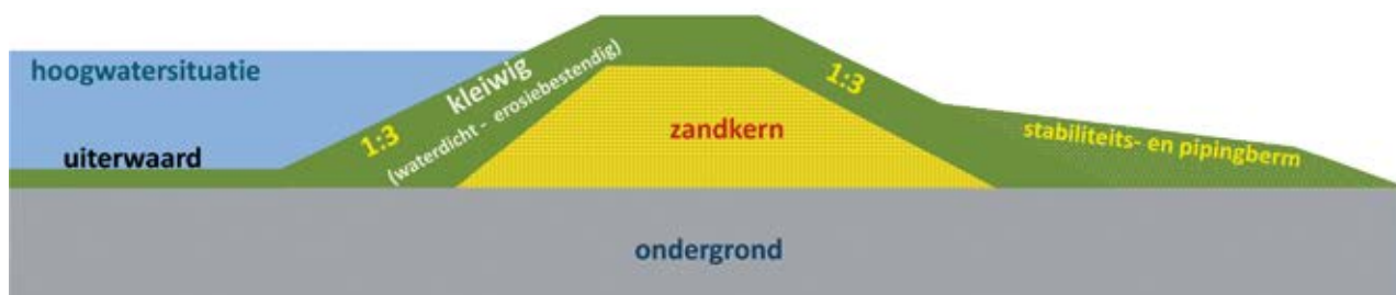
Figuur 2-20 Rivierdijk aan uiterwaard, geldt ook voor veel dijken in benedenrivierengebied (bron; Royal HaskoningDHV).
