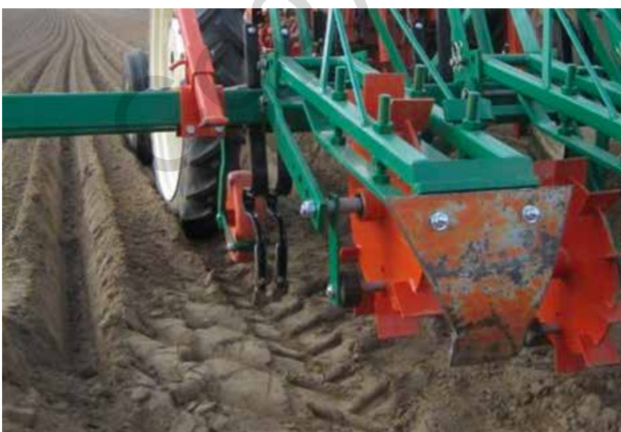
Erosiedrempels in de aardappelteelt aangelegd met Barbutte drempелеlementen
