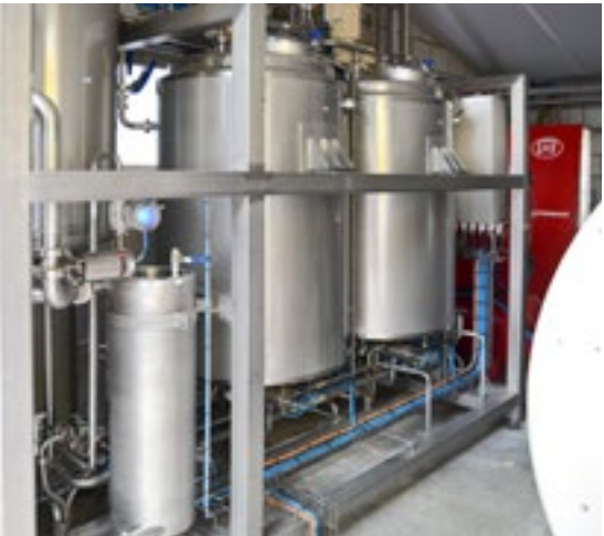
In beide buffers bij de robots zit de melk van één koe, die wordt na koeling in één van de twee buffers links of in de rauwmelkse tank (rechts) gepompt.
