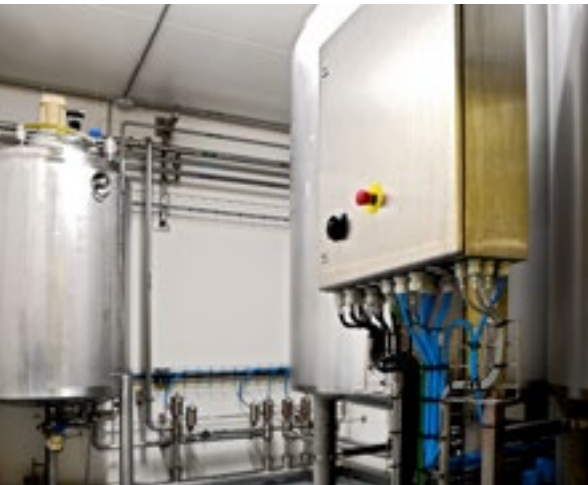
Na de pasteurisatie en verwerking worden de melk en room in tussentanks opgeslagen. Vervolgens kan de melk worden gebotteld.
