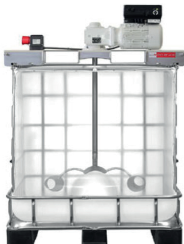
FIGUUR 67 1 M 3 MECHANISCH-GEROERD SLIBVAT ZOALS GEBRUIKT
