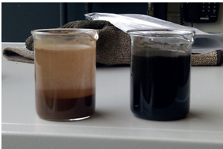
SEDIMENTATIE VAN VLEGAS EN KOLENGRUIS 1 MIN. NA UITSCHAKELING ROERDER
