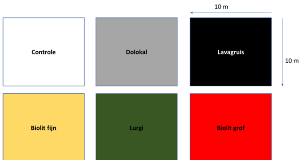
Figuur B1.6. Opzet van de proef op Strabrecht. In het terrein zijn 5 van deze blokken ingezet. De behandelingen werden per toeval over de proefvelden verdeeld. Ieder proefveld is 10 m bij 10 m groot.
