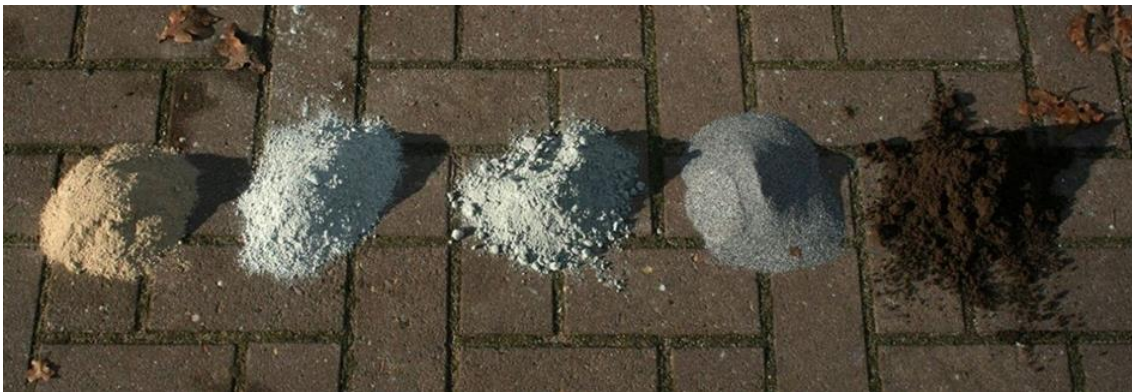
Foto S.1. Verschillende opgebrachte bufferstoffen in het experiment op Strabrecht. Van links naar rechts: Dolokal, Biolit (fijne maling), Biolit (grovere maling), Lurgi en Lavagruis.
