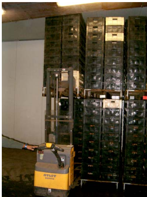
Figuur D1: Hoog stapelen van fust met bollen in bewaarcel, met behulp van elektrische hefwagen
