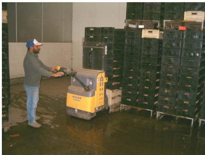
Figuur D4: Intern transport van bewaarcel naar klimaatcel, met een aangedreven steekwagen
