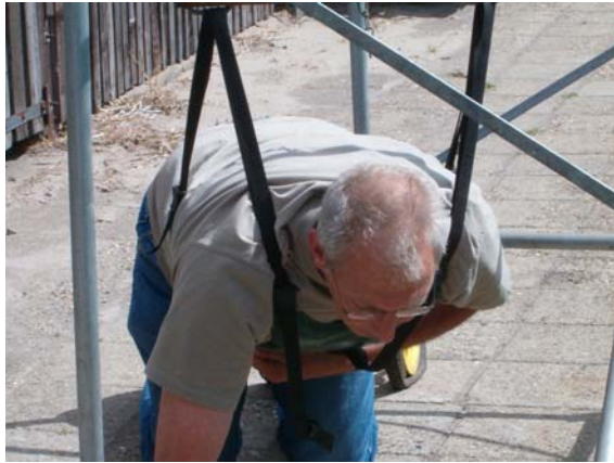
Figuur D2: Portaalwagen met hangtuigje om bovenlichaam af te steunen
