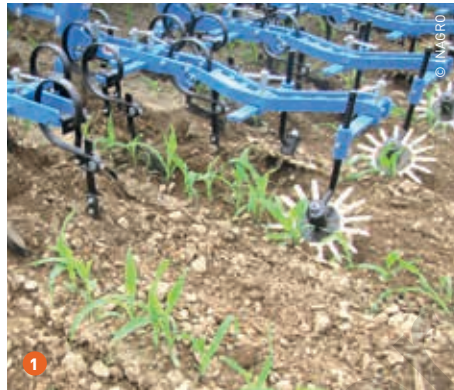
1 Ook de Carré Econet-schoffelmachine uitgerust met Precicam-stuurmodule herkent de onkruiden tussen het gewas. 2 Vanhoucke-schoffelmachine uitgerust met rijenbranders.
