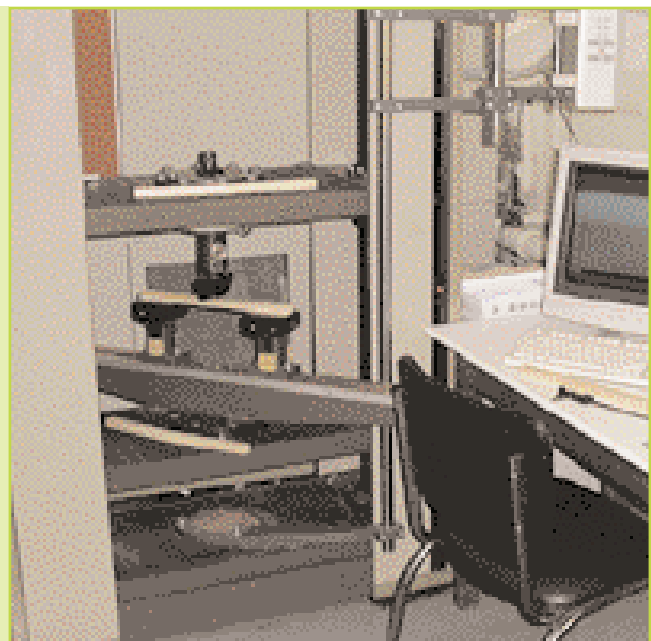
Opstelling voor de driepuntsbuigproef (foto Lieven De Boever).
