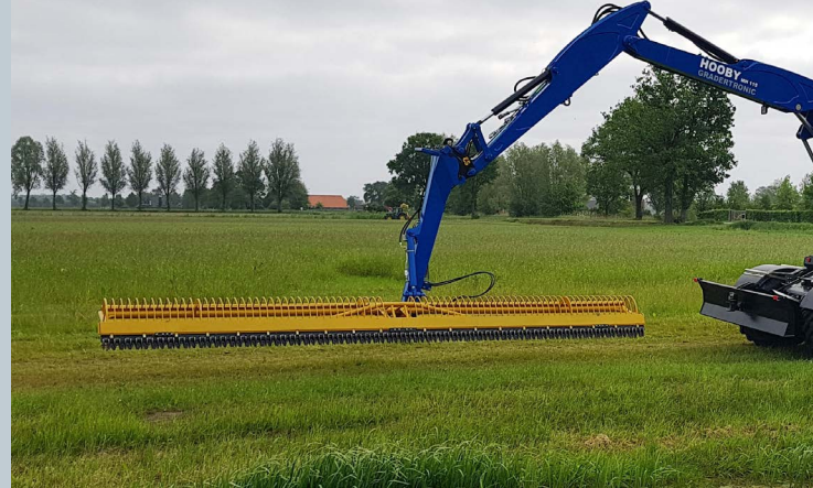
Voor het afleggen in lengterichting of lossen in een kipper zwenkt de maaikorf automatisch in de lengterichting.
