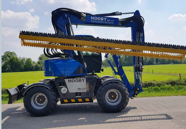
Voor transport is de maaikorf naast de cabine weggeklapt.
