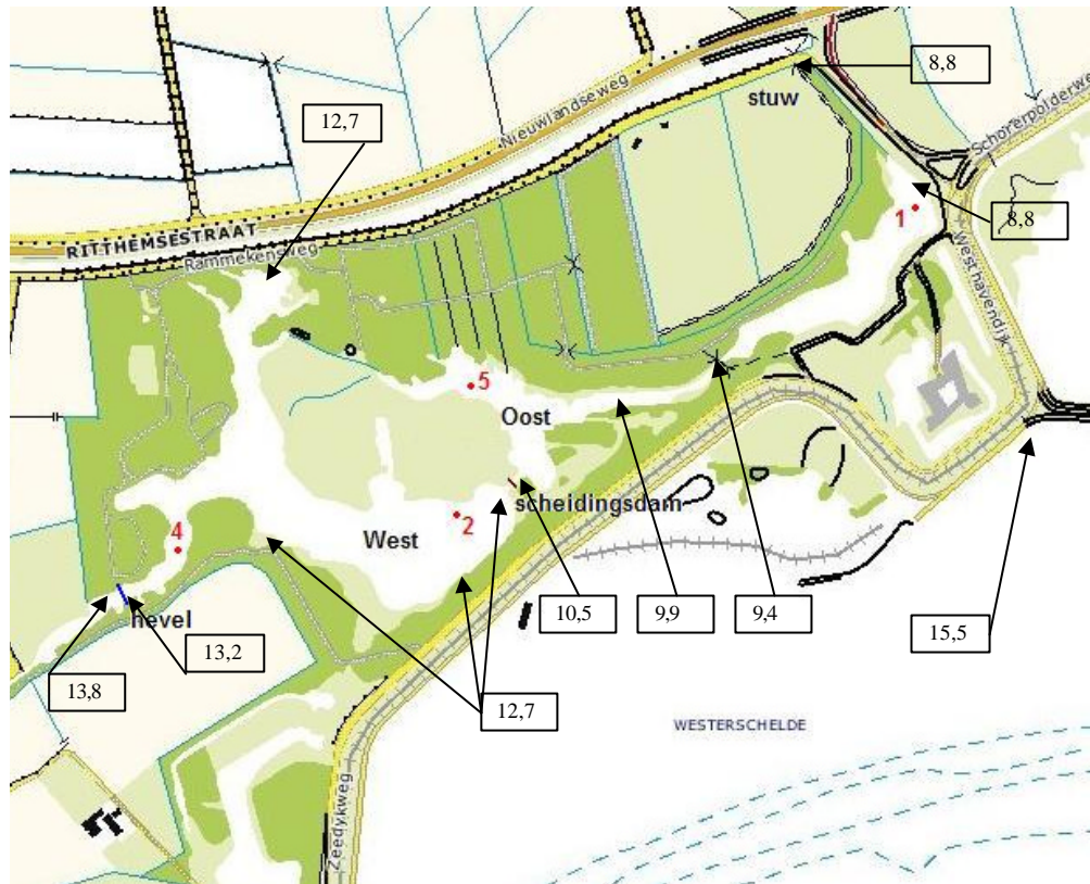
Figuur 1. Overzicht Rammekenscreek. In het westen de hevelvoorziening, in het midden de scheidingsdam en noordoostelijk de stuw voor afvoer van het oostelijk deel. In rood: monsterlocaties. In kaders: chloridegehalten n.a.v. veldbezoek januari 2005 (omgerekend vanuit saliniteit).
