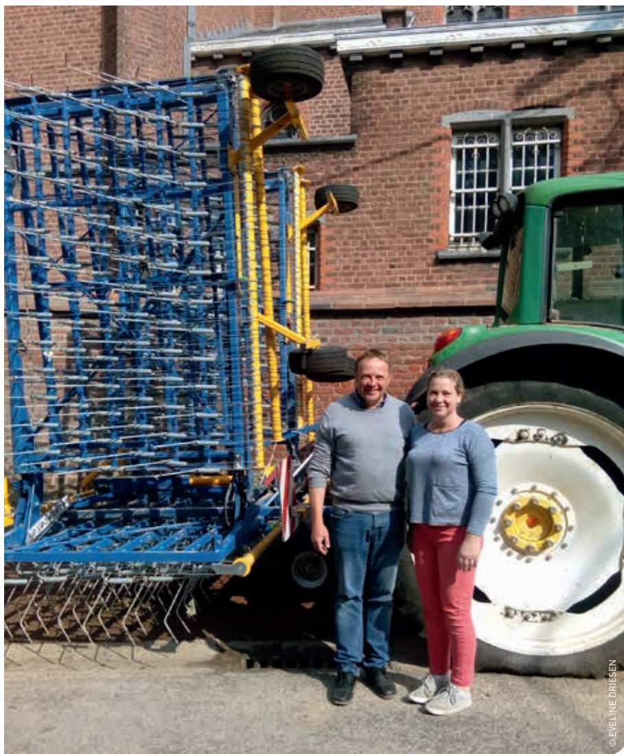
Laurent Streef en zijn vrouw Astrid kochten vorig jaar deze Treffler-wiedeg. Die biedt als voordeel dat de druk op de tanden vanuit de cabine kan aangepast worden, bijvoorbeeld om minder druk te geven in de rijen.
