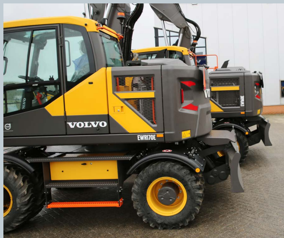
Ten opzichte van de EWR160E is de zwenk-radius van de EWR170E 36 centimeter kleiner, hier duidelijk in beeld gebracht.
