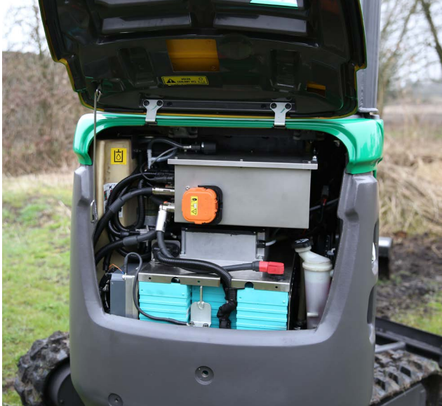
Het nieuwe hart van de machine met plaats voor de accu en de aansturing van het geheel.
