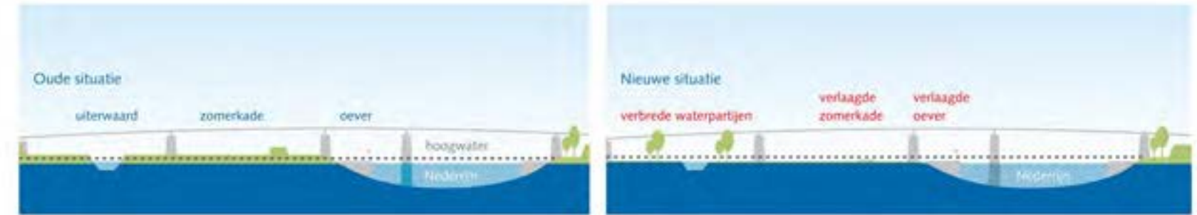
Er wordt meer afvoercapaciteit gecreëerd, onder andere door de zomerkade en de rivieroever te verlagen.
