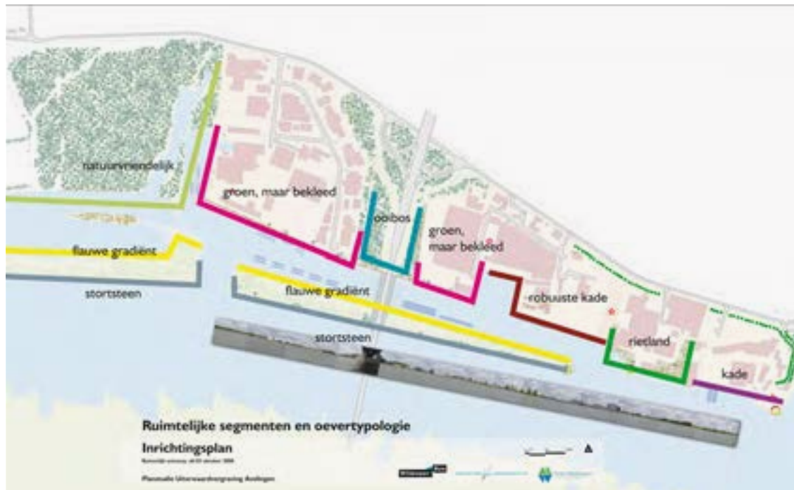
Ontwerpschets van de opbouw van de samenhangende oevers
