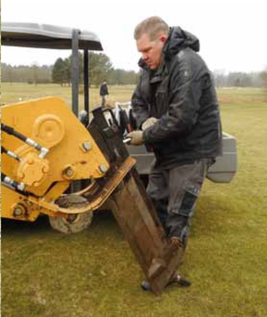
Het sleuvengraafmes op de inploegmachine wordt vervangen door een snijmes.
