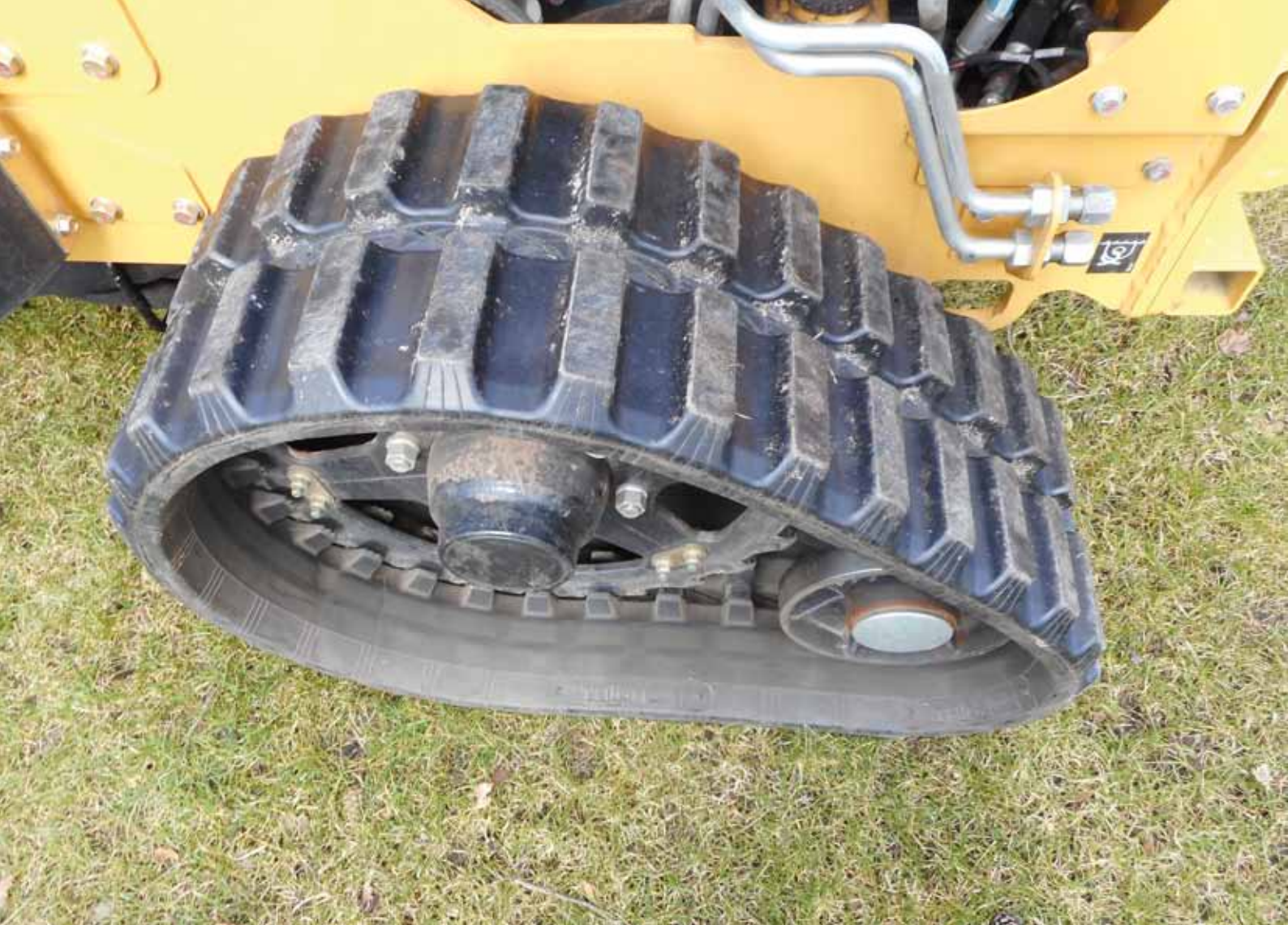
Mede door zijn rupsbanden veroorzaakt de Vermeer PTX40 geen schade.
