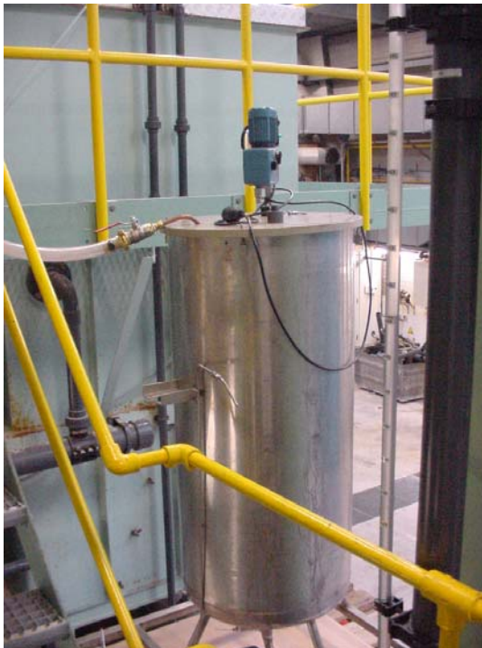
Figuur 6 Het 200-liter vat voor de dosering van micro-organismen
