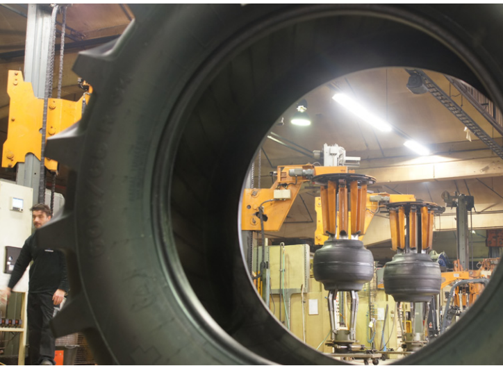
In de fabriek in Enschede komen de eerste nieuwe banden inmiddels uit de oven. Op de foto de halffabrikaten.
