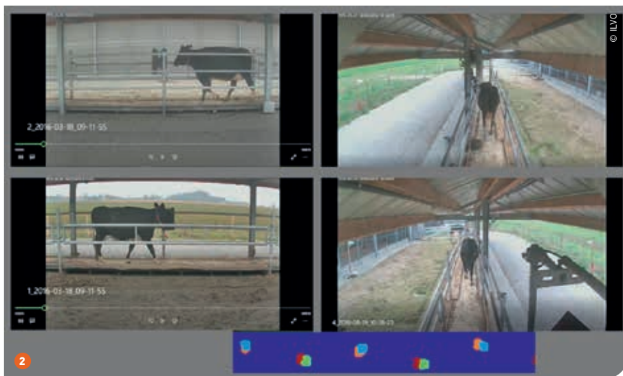
1 Buitenaanzicht van de Gaitwise. Druksensoren registreren waar en hoe een koe haar poten neerzet. 2 Camerabeelden laten zien hoe de koe over de Gaitwise stapt.
