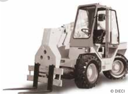
De eerste verreiker van Dieci kwam in 1983 op de markt. Destijds werd de giek achteraan gebouwd boven de motor.
