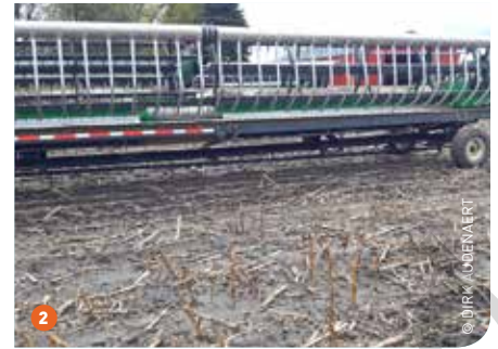
1 De meeste machines, zoals deze twaalfscharige ploeg, blijven in de winter gewoon buiten staan. Een loods is te duur volgens loonwerker Ben. 2 Het maaibord van de oogstmachine voor sojabonen is voorzien van luchtpijpen om de sojapeulen in de machine te blazen.
