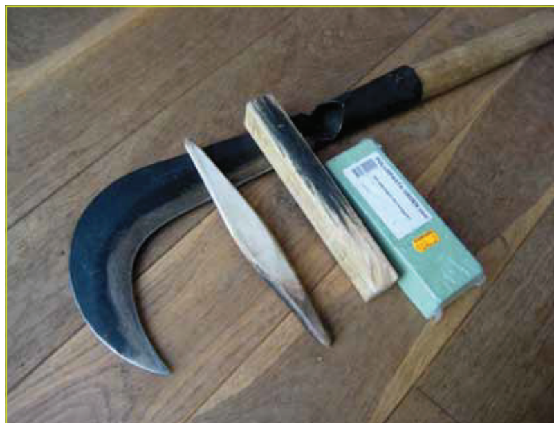
Figuur 2: De kapmessen bewijzen enkel hun nut als ze goed scherp gehouden worden met een wetsteen of polijstpasta.
