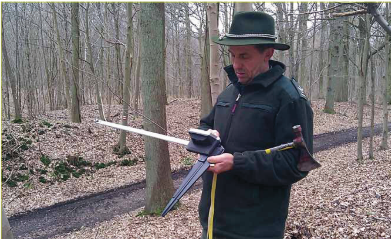
Figuur 2: De Excaliper van Savcor Masser is een van twee geteste modellen tweehandige meetklemmen. © Inverde
