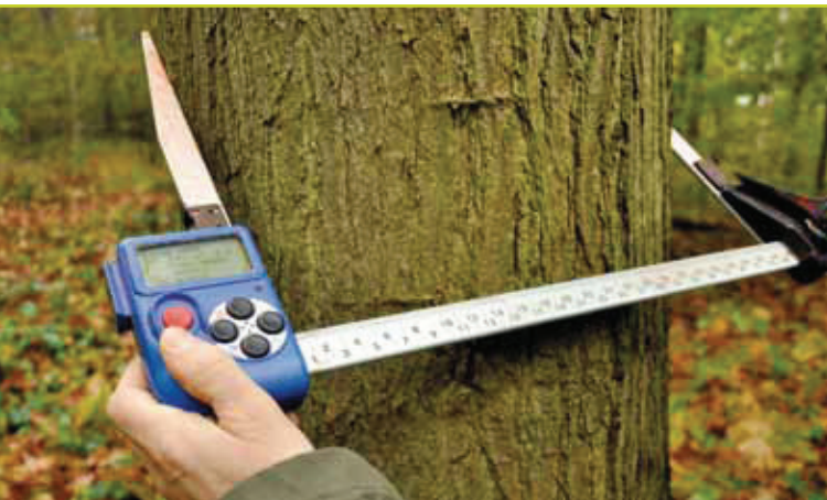
Figuur 4: Voor de software in de meetklem is vertrokken van de situatie op terrein. Gebruiksvriendelijkheid voor de eindgebruiker moet zorgen een tijds winst op het terrein. Een boswachter kan bijvoorbeeld tussentijds het volume opgemeten hout opvragen. Dit kan handig zijn bij het samenstellen van brandhoutloten voor verkoop aan particulieren met een maximum volume van 50 m 3 . © Inverde
