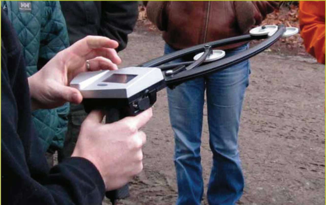
Figuur 3: De Racal TWC van Savcor Masser heeft een meetbereik van 2,60 m diameter. Tot een diameter van 31,6 cm betreffen het rechtstreekse metingen, waarbij de meetklem het breedste punt tussen de benen registreert. Voor diameters groter dan 31,6 cm wordt de boog berekend op basis van drie meetpunten (met het derde rolelement). Hieruit volgt dan de diameter. © Inverde
