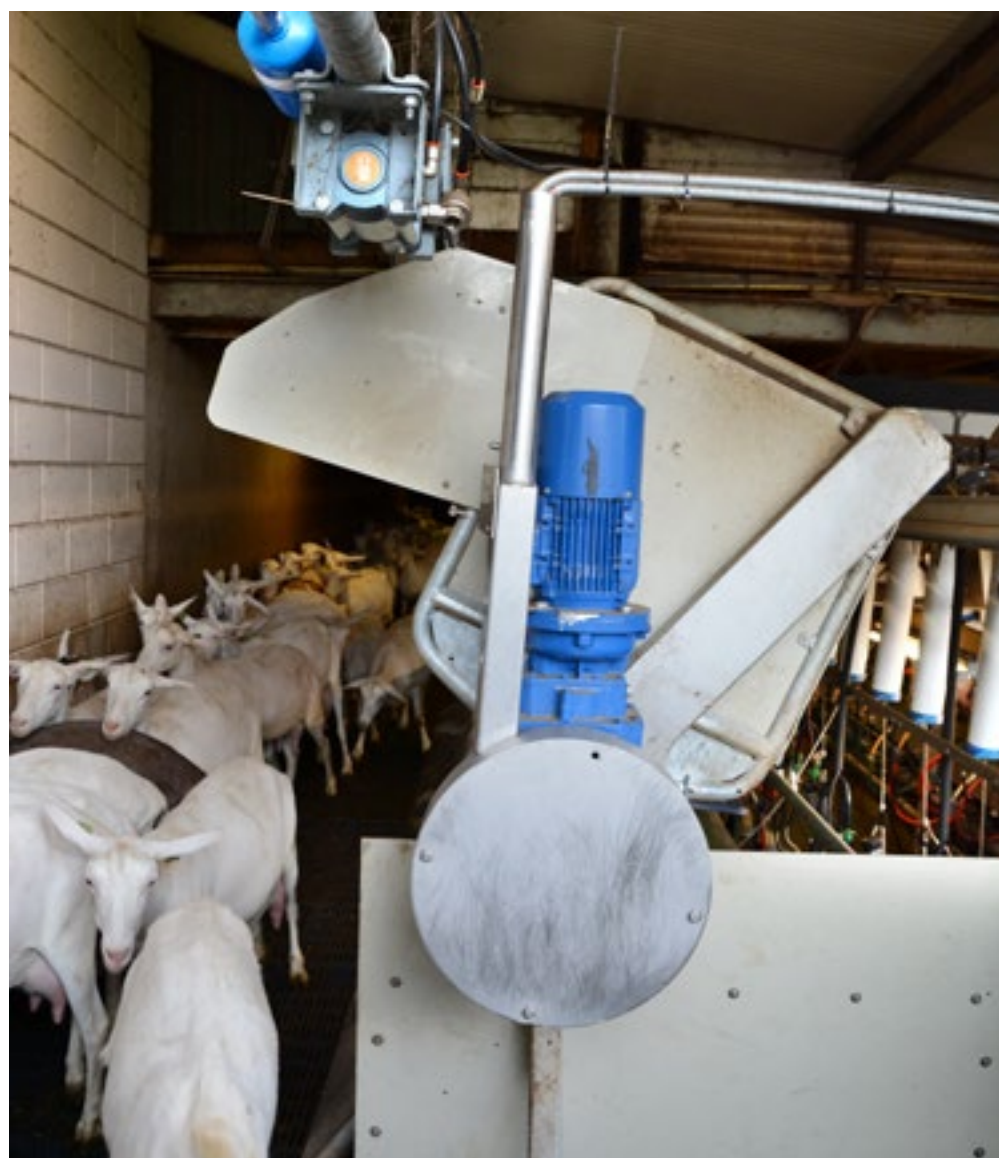
De melkstanden hangen nu in de lucht en draaien verder door, zodat er weer een lege rij standen ontstaat.
