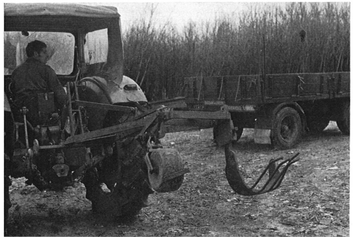
Trekker met aanbouwploeg in de hefinrichting.
