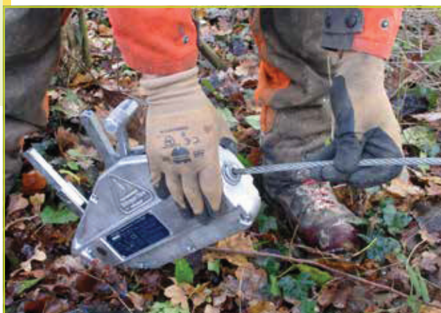
Figuur 2: Om de kabel in de handlier te kunnen steken, moet de kleine hendel 'open' staan om de klembekken uit elkaar te drukken. Controleer of de kabel goed voorbij het bevestigingspunt komt voordat je de handlier gaat gebruiken.
