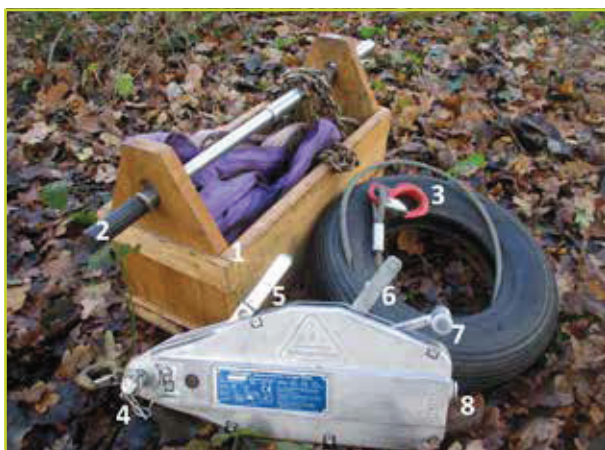
Figuur 1: Een volledige handlierset: draagkist met toebehoren zoals eindloze stropen en een aanslagketting (1), bedieningshefboom of stalen buis (2), gepunte trekkabel met specifieke diameter (3), bevestigingssoog met uitneembare pen en haak (4), hendel om te trekken met ingebouwde breekpin (5), hendel om gecontroleerd te lossen (6), hendel om de kabel los te zetten (7) en inlooppunt van de kabel (8).
