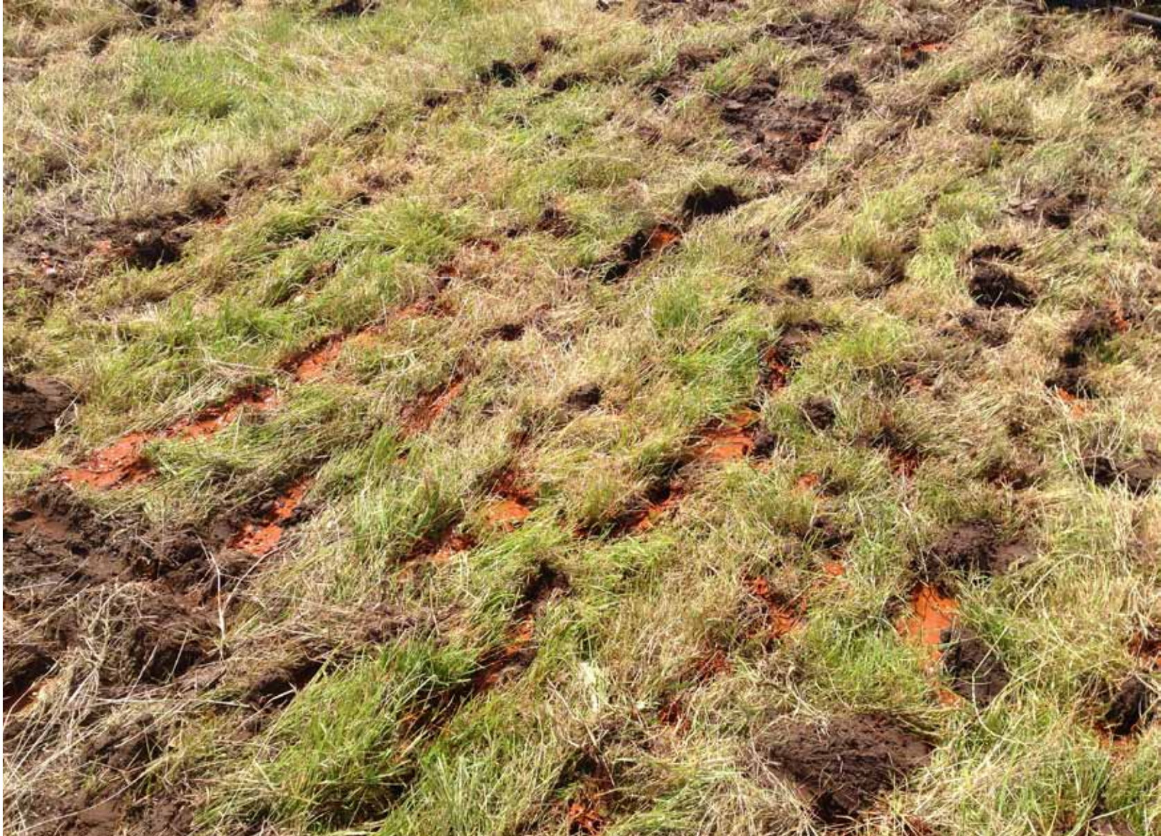
Figuur 3. Het drinkwaterslib wordt in parallelle snedes tussen en onder de graszode ingebracht.
