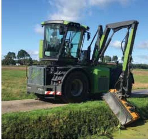
De Exentric van Hemos heeft twee gieken die beiden onder het voertuig ingeklapt kunnen worden voor onbelemmerd zicht in het verkeer.
