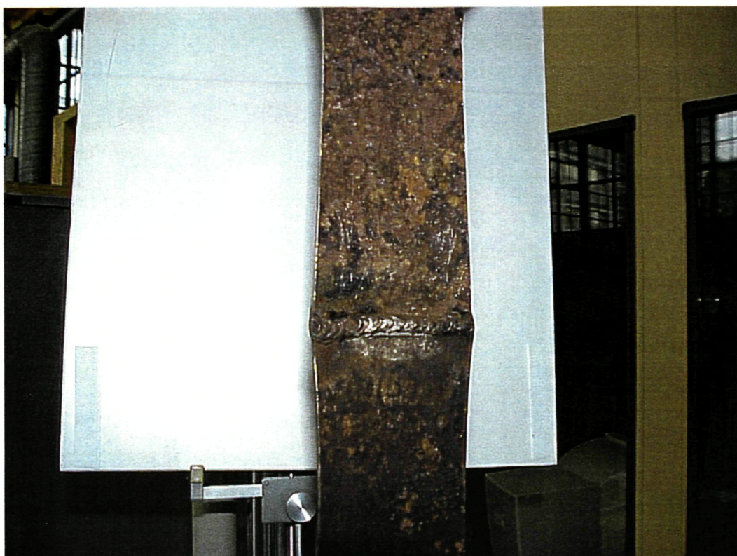
Figuur 8 – Proefstuk 2 kort voor breuk (insnoering zichtbaar boven en onder de las)
