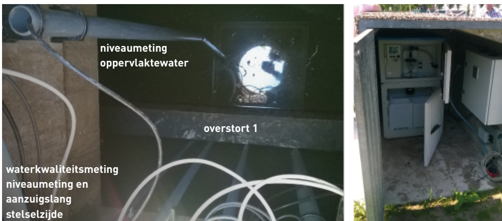
Figuur 2.11 Niveau- en waterkwaliteitssensoren bij overstort 1 (locatie A, links) en monsternamekast in vandalisembestendige behuizing (rechts)
