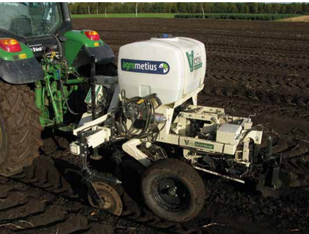
De kouters zitten in een rechte lijn achter elkaar. Een signaal beweegt via een omweg door de bodem tussen de kouters.
